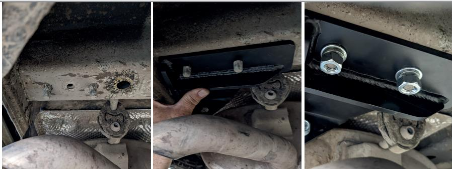
**ШАГ 3.** Закрепите балку ТСУ на правом и левом кронштейнах при помощи болтов M10x1,25x35, шайб 10, шайб 10 гроверных и гаек M10x1,25. **Затяните все соединения, отрегулировав положение ТСУ.**
