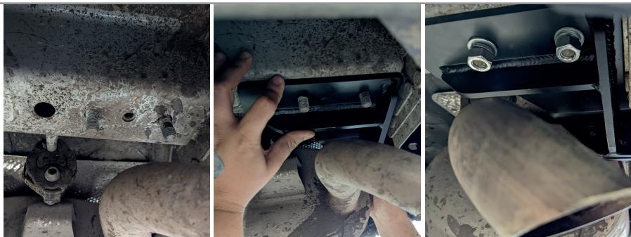
**ШАГ 2.** Зафиксируйте положение правого кронштейна на штатных шпильках возле правой подушки крепления глушителя при помощи гаек M12, шайб 12 и шайб 12 гроверных.
